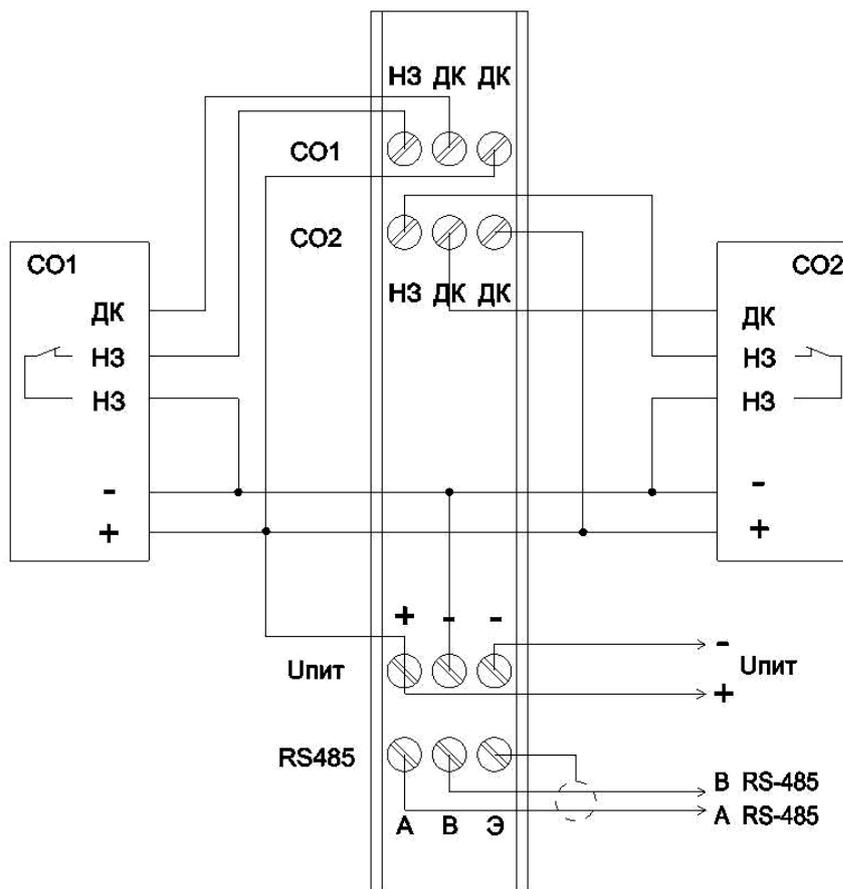
Рисунок 1.2 – Схема подключения с использовани ДК
