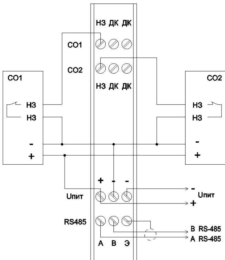
Рисунок 1.1 – Схема подключения без использования ДК
